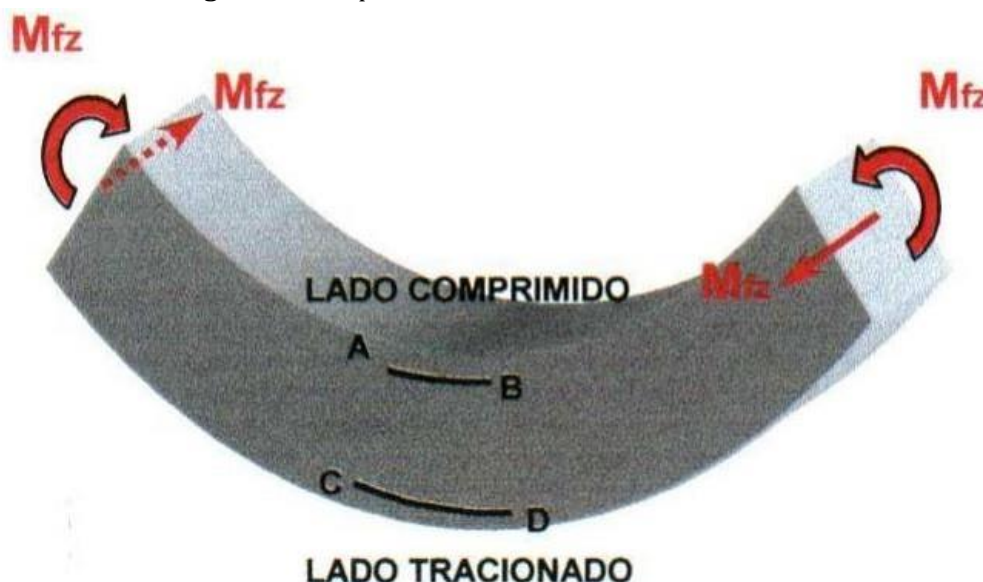
Figura 1 – Comportamento de um elemento reto flexão
