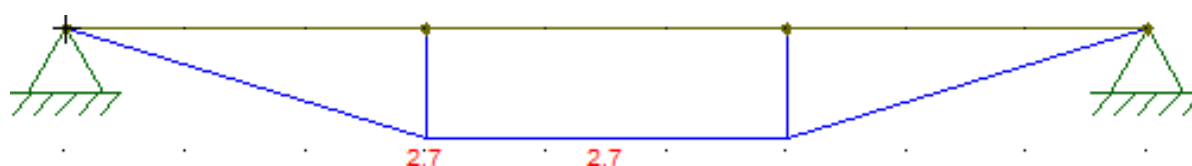
Figura 12: Gráfico do Momento Fletor (KN.m por m)
