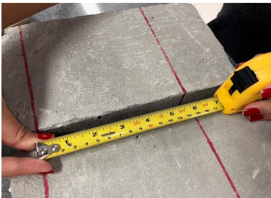
Figura 6 – Processo de Seleção, Medição e Demarcação da viga de concreto utilizada
