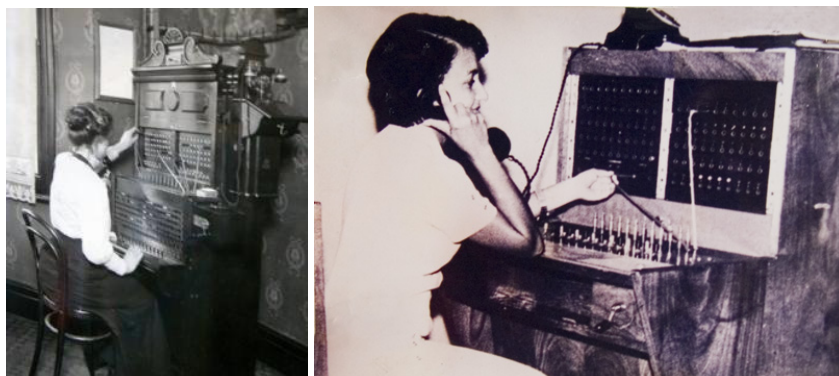
Figura 2 – Antiga central telefônica utilizando chaveamento físico manual
