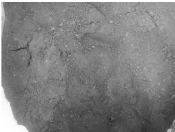
Figura 7: Detalhe do resíduo de construção civil e/ ou demolição já beneficiado, areia reciclada de granulometria similar a areia fina natural.
