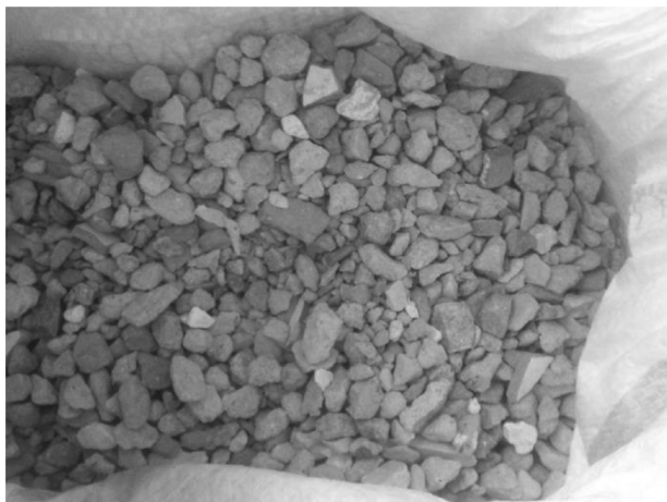
Figura 6: Vista do resíduo de construção civil e/ ou demolição já beneficiado, com granulometria de 9 mm (cascalinho).
