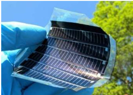
Figura 10 -Filme fino de disseleneto de cobre-índico
