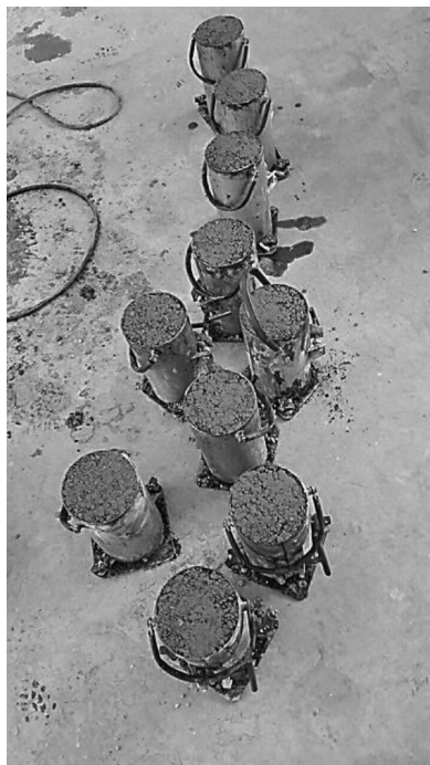
Figura 8: Vista dos CP's 15x30 moldados e aguardando o período de 24 horas, para serem desmoldados.
