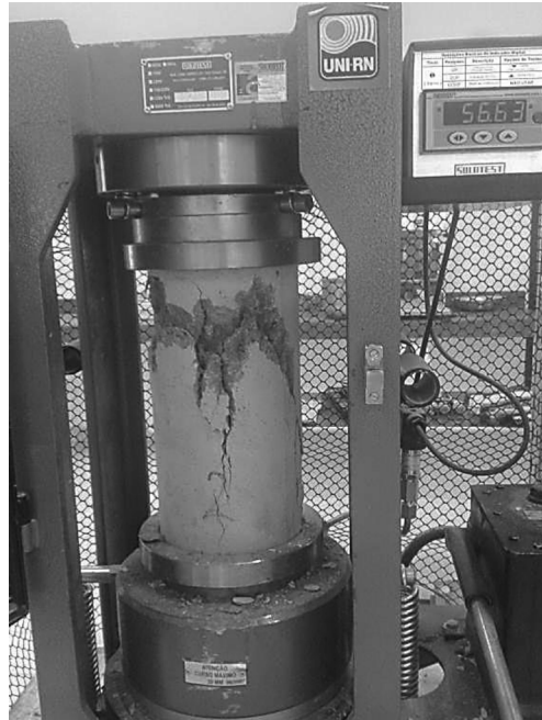
Figura 11: Vista do ensaio de resistência à compressão.
