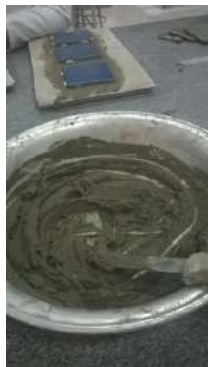
Figura 8 - Argamassa colante industrial ACII do fabricante "B" pronta
