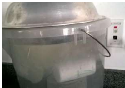
Figura 15 - Corpos de prova submersos
