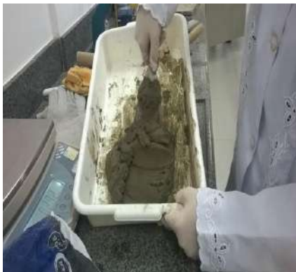
Figura 1 - Finalização da argamassa colante industrial ACI do fabricante "A"
