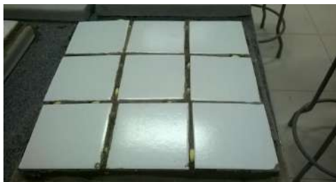
Figura 9 - Placas cerâmicas assentadas para realização do ensaio do Pull-Off
