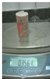
Figura 16 - Peso saturado corpo de prova da argamassa de rejunte do fabricante "A"
