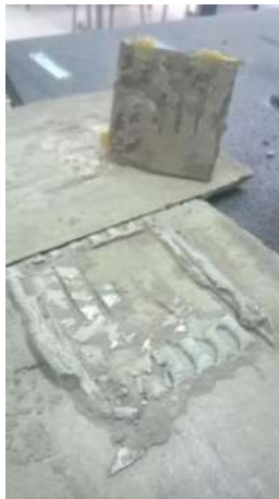
Figura 5 - Arrancamento do Corpo de prova da argamassa colante industrial ACII do fabricante "A"
