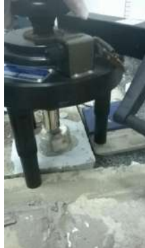
Figura 7 - Ensaio do Pull-Off no corpo de prova da argamassa colante industrial ACI do fabricante "B"
