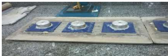
Figura 3 - Preparação dos corpos de prova da argamassa industrial colante ACI do fabricante "A" para o ensaio do Pull-Off
