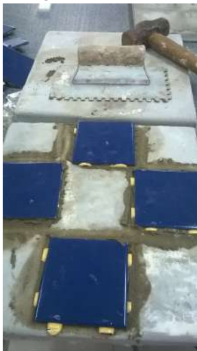
Figura 6 - Corpos de prova da argamassa colante industrial ACIII-E do fabricante "A"
