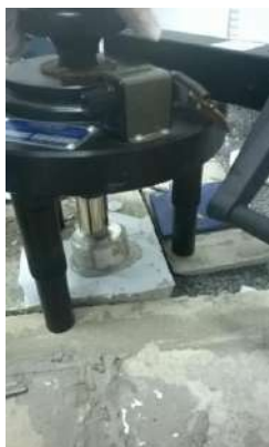
Figura 4 - Ensaio do Pull-Off no corpo de prova da argamassa industrial colante ACI do fabricante "A"
