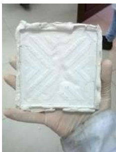
Figura 12 - Argamassa colante industrial ACII-E do fabricante "B" após a realização do ensaio do Pull-Off
