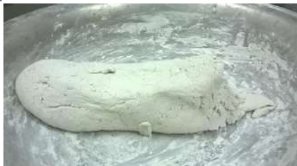
Figura 10 - Textura e consistência da argamassa colante industrial ACIII-E do fabricante "B"
