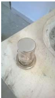
Figura 14 - Corpo de prova de rejunte do fabricante "A"
