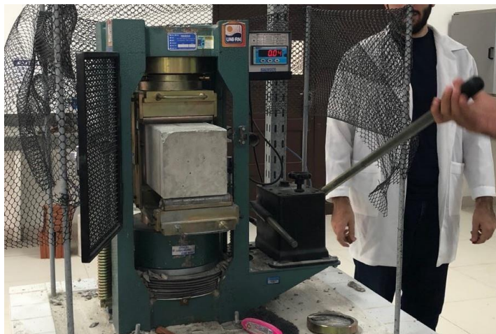
Figura 9 – Aparelhagem e Colocação da Viga de Concreto de 50 cm por 15 cm no eixo horizontal entre os pratos da prensa para o processo de ruptura
