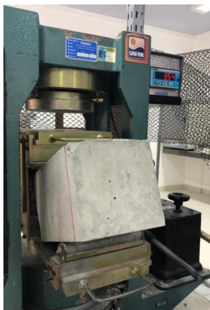
Figura 10 – Ruptura da viga de concreto e verificação da força (TF) aplicada pela prensa hidráulica
