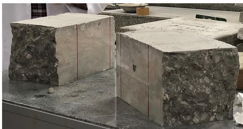
Figura 16 – Ruptura da viga de concreto devido a carga aplicada pela prensa hidráulica
