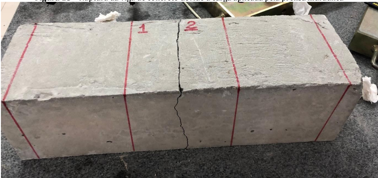
Figura 15 – Ruptura da viga de concreto devido a carga aplicada pela prensa hidráulica
