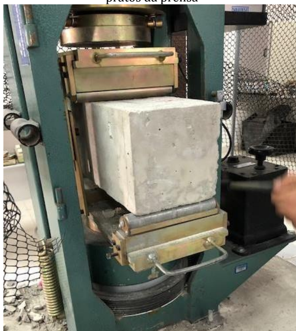
Figura 8 – Aparelhagem e Colocação da Viga de Concreto de 50 cm por 15 cm no eixo horizontal entre os pratos da prensa
