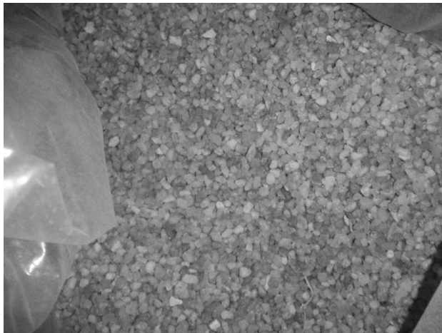
Figura 5: Detalhe do rejeito de indústria de argamassa, material granular retido na peneira 2,4 mm (areia grossa).
