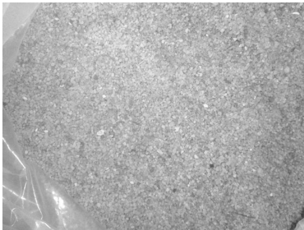
Figura 4: Vista do rejeito de indústria de argamassa, material granular retido na peneira 1,18 mm (areia média).
