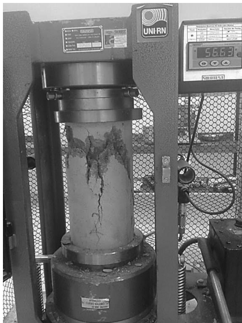
Figura 11: Vista do ensaio de resistência à compressão.
