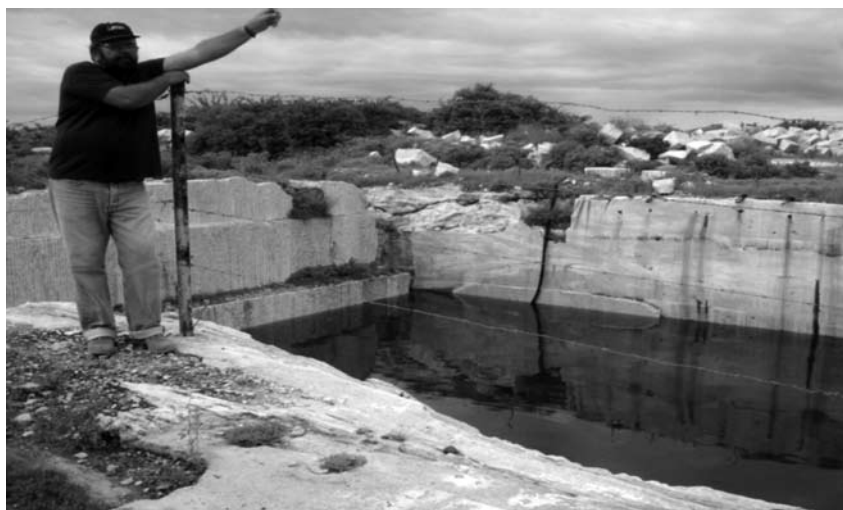
Fotografia 2: Cava de extração de blocos mármore em sucessivas bancadas com o tamanho do bloco. Uma frente feita por fio helicoidal e outra por martelo de perfuração.
