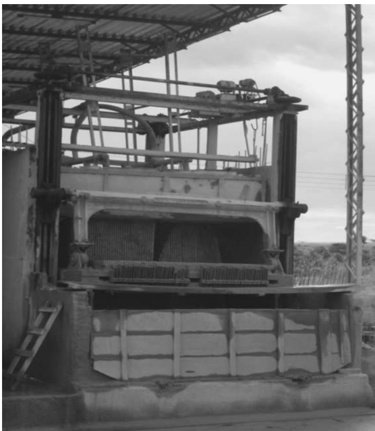
Fotografia 4: Corte do bloco em tear de multi-lâminas e lama abrasiva
