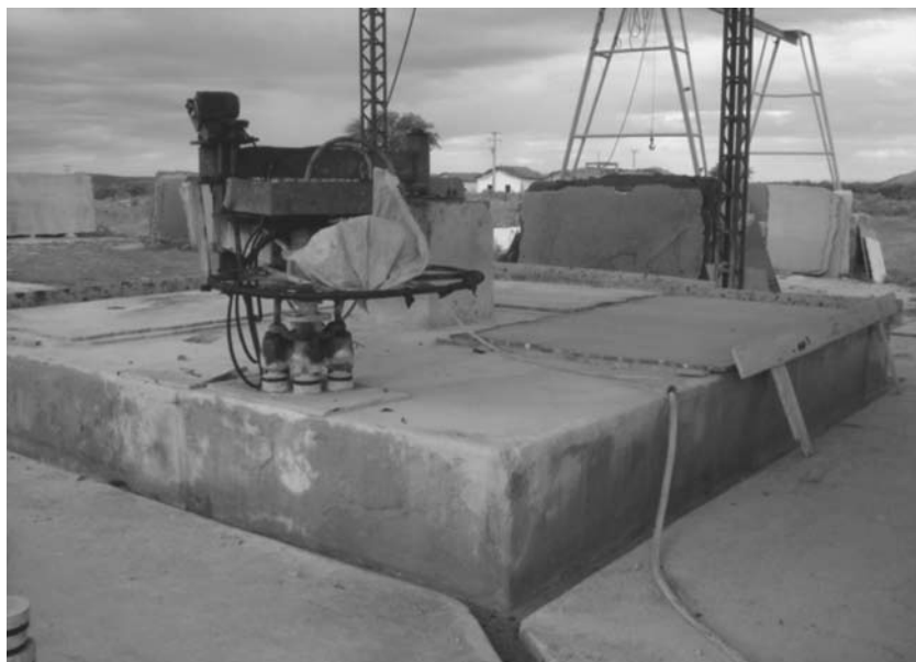
Fotografia 5: Politriz manual para acabamento das placas
